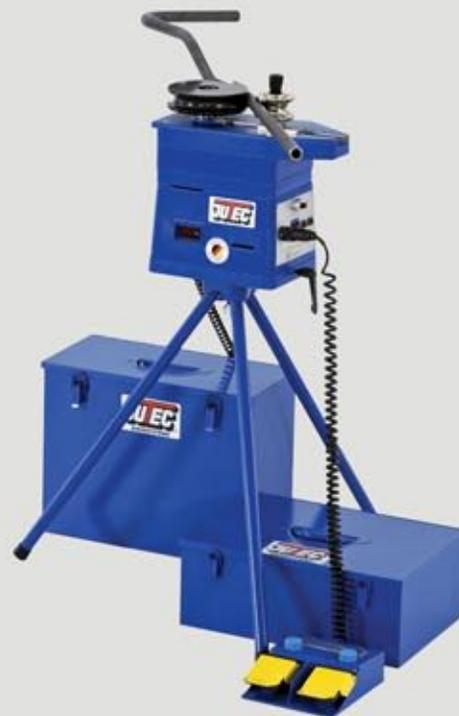
Для тонкостенных труб, чтобы избежать появления гофры, а также для гибки труб из таких материалов как, например, нержавеющей стали или медь, с наименьшей деформацией используется скользящий башмак с эксцентриковым прижимом. Толстостенные трубы можно гнуть с контроликом. Насадка RB20 (опция) позволяет гнуть без проблем полосы и прутки.
