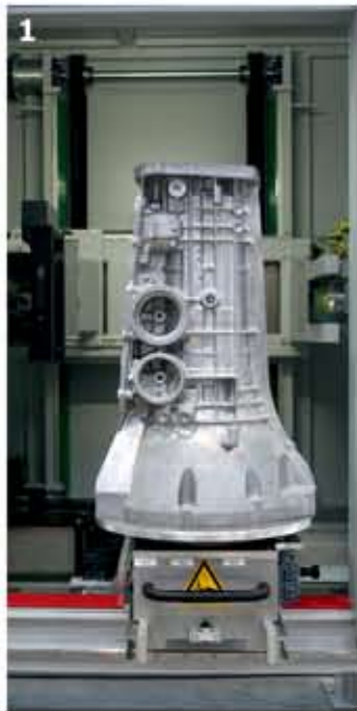
1 Отливка на поворотном столе 2 Загрузка и выгрузка снаружи кабины
