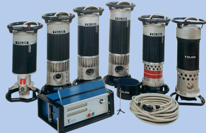
Малый вес и компактность этих аппаратов делают их идеальными для контроля в полевых условиях. Высокочастотная ключевая техника дает высокую стабильность выходных параметров и очень короткие экспозиции.
