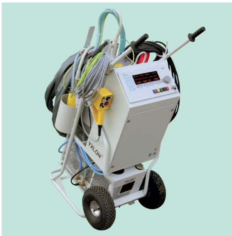
Компактные рентгеновские аппараты постоянного напряжения Y.XMB160 и Y.XMB225 разработаны специально для мобильного применения. Благодаря очень высокой мощности, они пригодны для контроля широкого круга объектов – от низкоплотных композиционных материалов до алюминиевых и стальных деталей.
